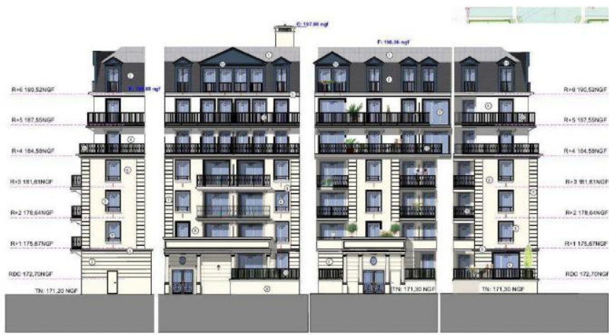
Bât 1 - F3a Bât 1 - F3b Bât 1 - F3c Bât 1 - F3d Bâtiment 1, façades, PC 5b2, dossier Urbanita
